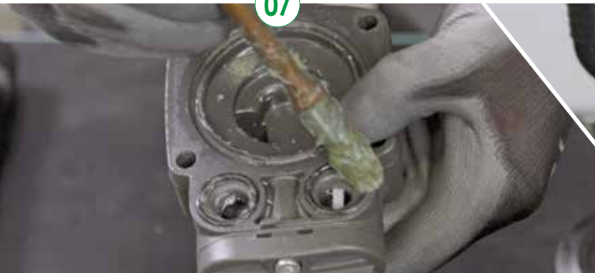
Substitute and then grease the o-rings on the pump head. | Ingrassare le nuove guarnizioni e sostituirle alle precedenti sulla testata.
