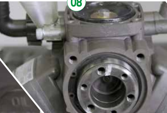
Rotate the pump shaft to bring the piston to the bottom and then mark it. | Ruotare l'albero per portare il pistone verso il basso e quindi contrassegnarlo.
