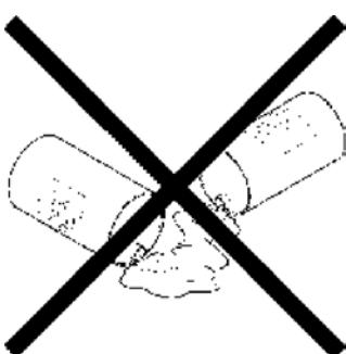
Не используйте подметальную машину в непосредственной близости от источников тепла (огня, радиаторов, тепловентиляторов и других излучающих тепло приборов).
